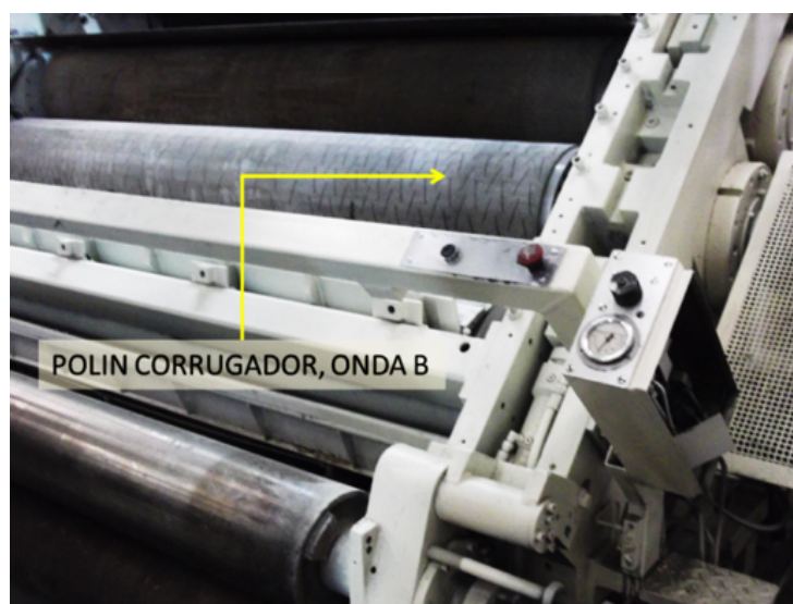
Figura 5.5: Polín corrugador. (Fuente: Planta Buin Sur.)
