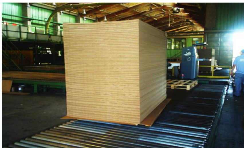
Figura 5.8: Paletizado automático. (Fuente: Planta Buin Sur.)
