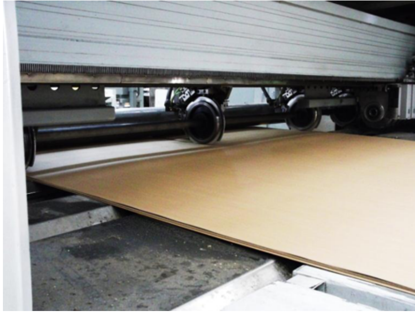
Figura 5.7: Slitter, máquina de corte longitudinal . (Fuente: Planta Buin Sur.)
