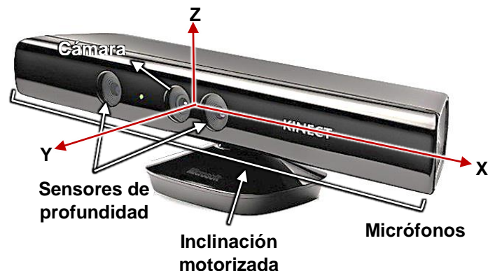
Figura 2.16. Principales componentes de un sensor Kinect
