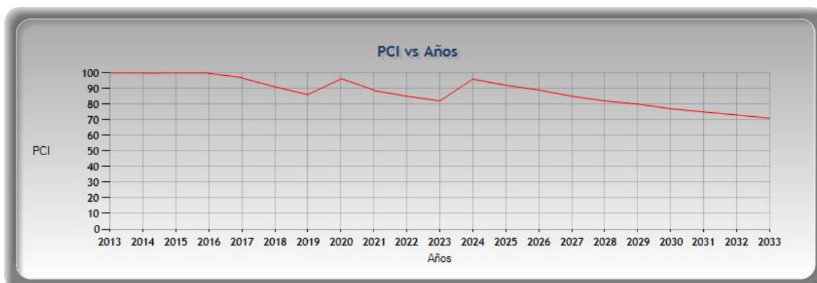
Figura 8. Evolución proyectada del PCI para la sección PI-1 (pista central) a 20 años.
