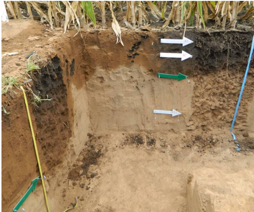
Figura 1.1: Ejemplo de calicata a cielo abierto.
