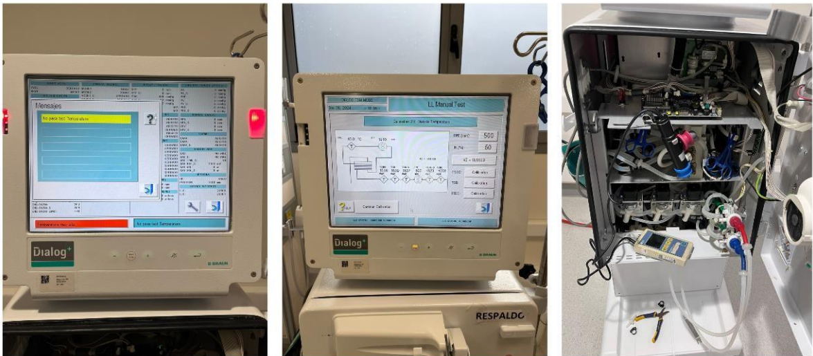
Figura 2-44 Calibración de sensores de temperatura en equipo DIALOG
