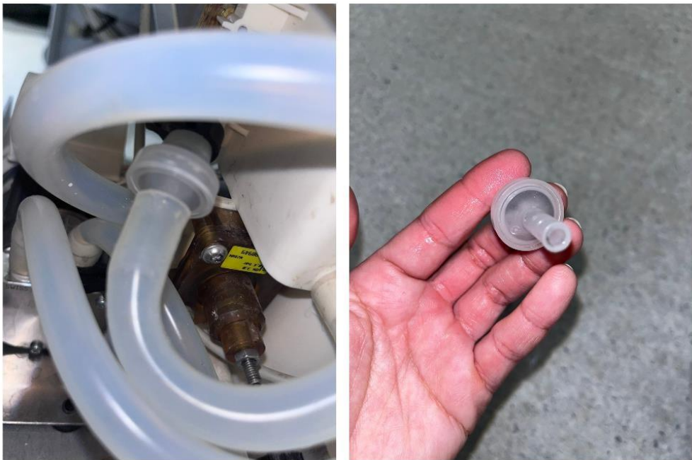
Figura 2-45 Filtro de línea obstruido
