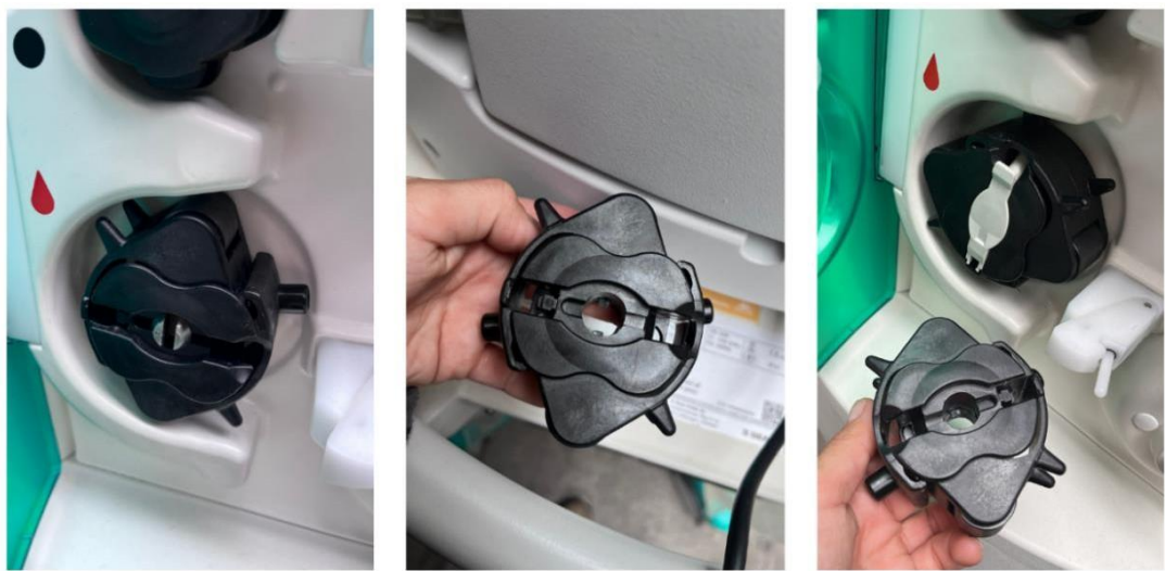
Figura 2-23 Reemplazo de rodillo en mal estado
