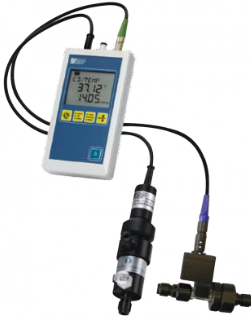
Figura 1-18 Calibrador de diálisis - Modelo HDM96 Pocket IBP
