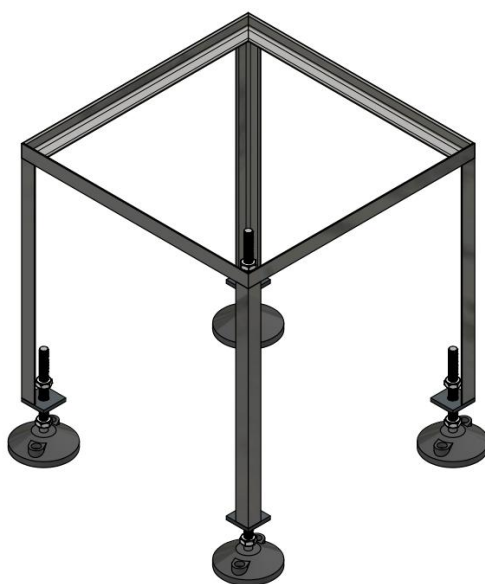
Imagen 4.5: Soporte de silo
