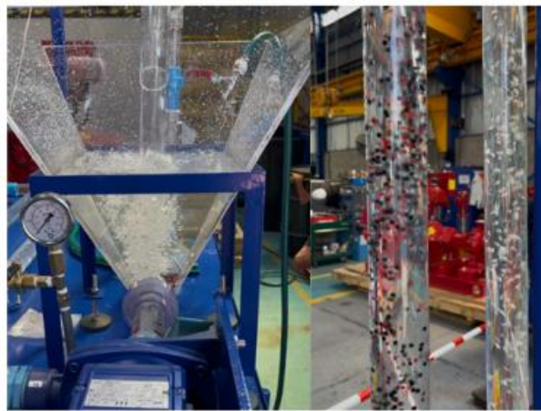
Imagen 5.11: Generación de burbujas en silo y tubería
