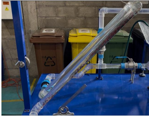
Imagen 5.8: Tubería abatible A y B
