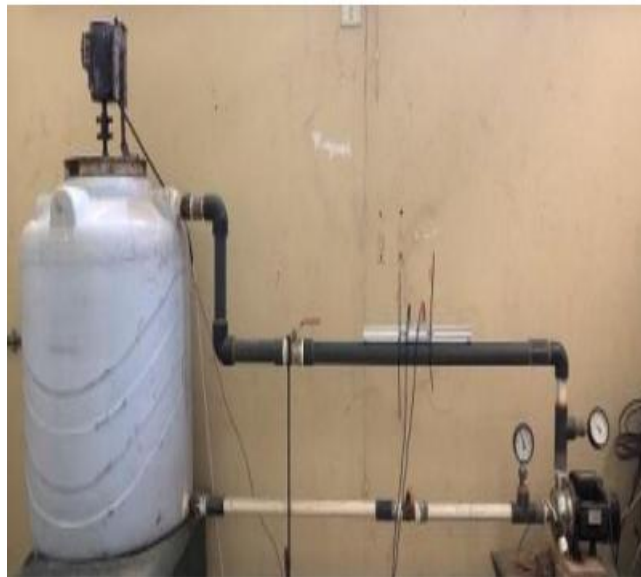
Imagen 2.6: Banco de ensayo para bomba de pulpa (El-Agouz, Mohamed, & Nossir, 2020).
