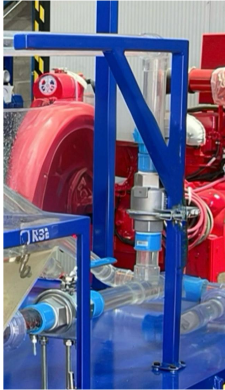
Imagen 4.8: Soporte vertical de válvula
