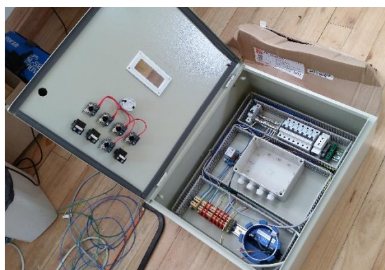
Figura 2-12. Tablero montado y cableado
