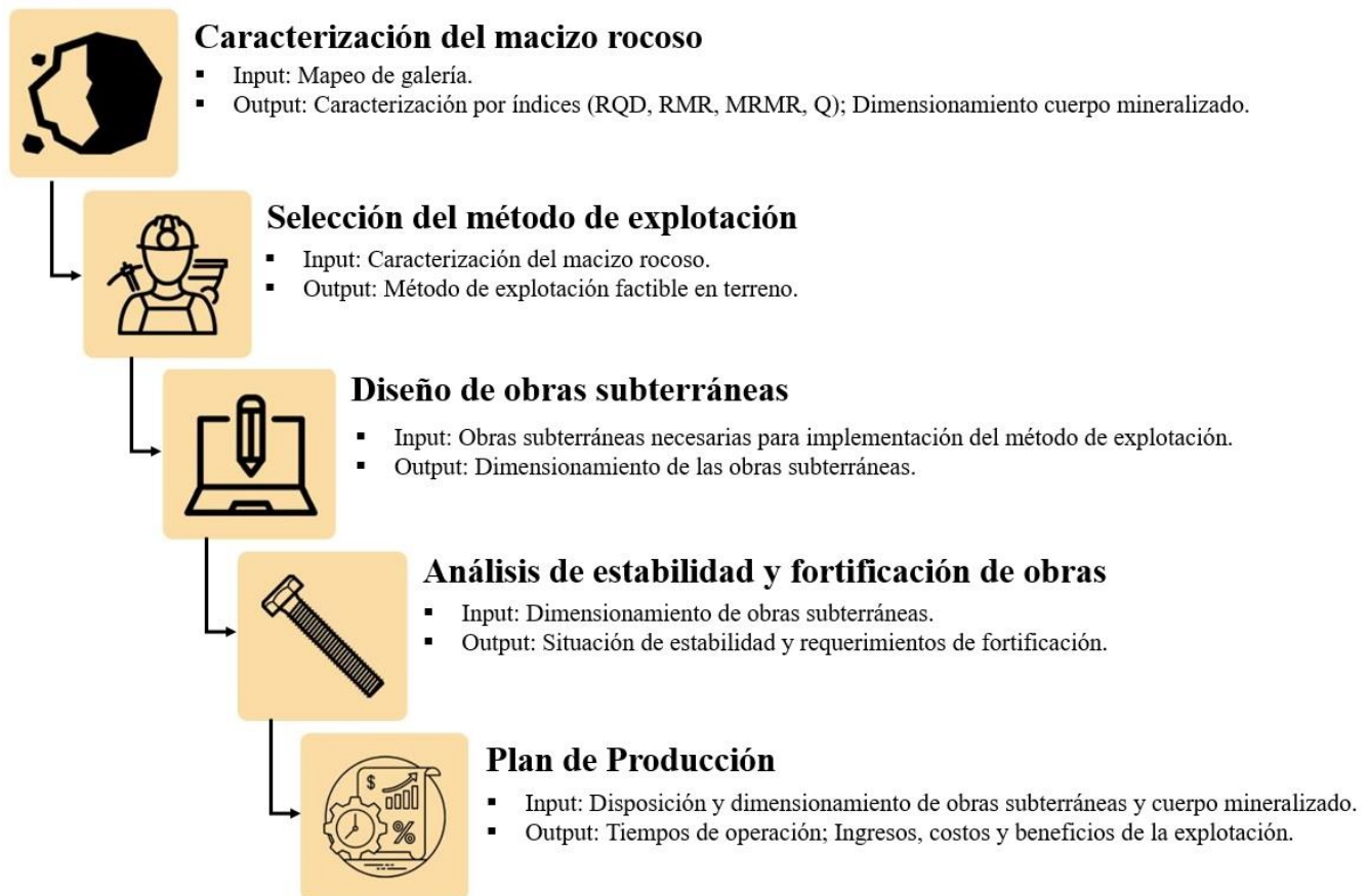
Ilustración 3: Diagrama de flujo de las tareas a realizar según la metodología de estudio planteada. Se presentan los principales input de cada una de las tareas y los output esperados.
