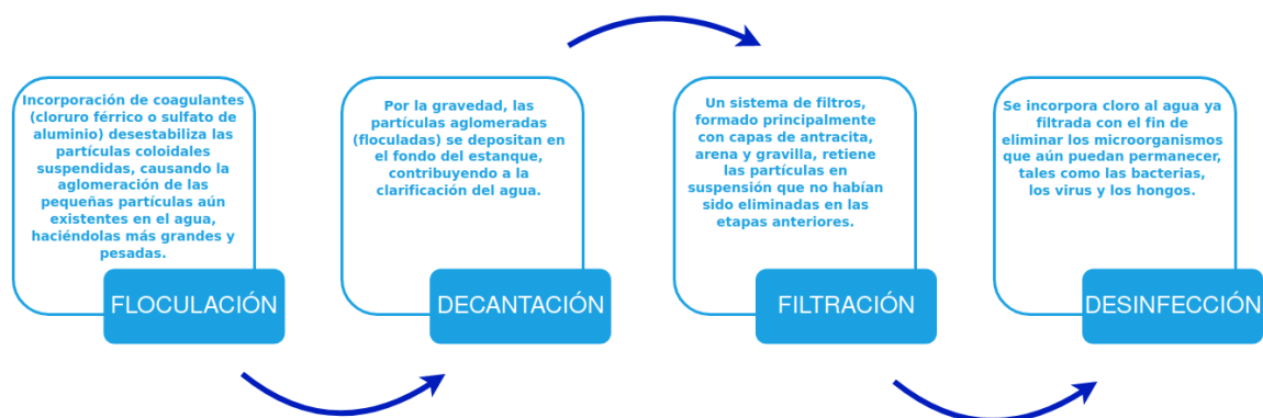
Figura 2.3: Etapas de Potabilización. Fuente: Reporte de sostenibilidad Esval 2020.
