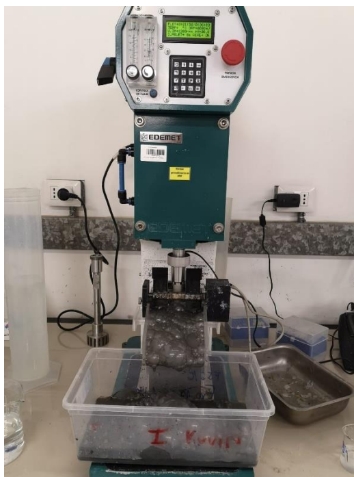
Figura 24: Celda de Flotación Edemet.
