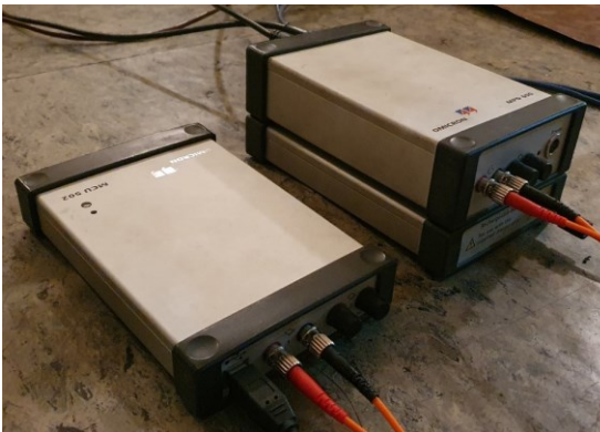
Equipo de medida de Descargas Parciales (DP) OMICRON MCU 502 y calibrador de DP Presco AG
