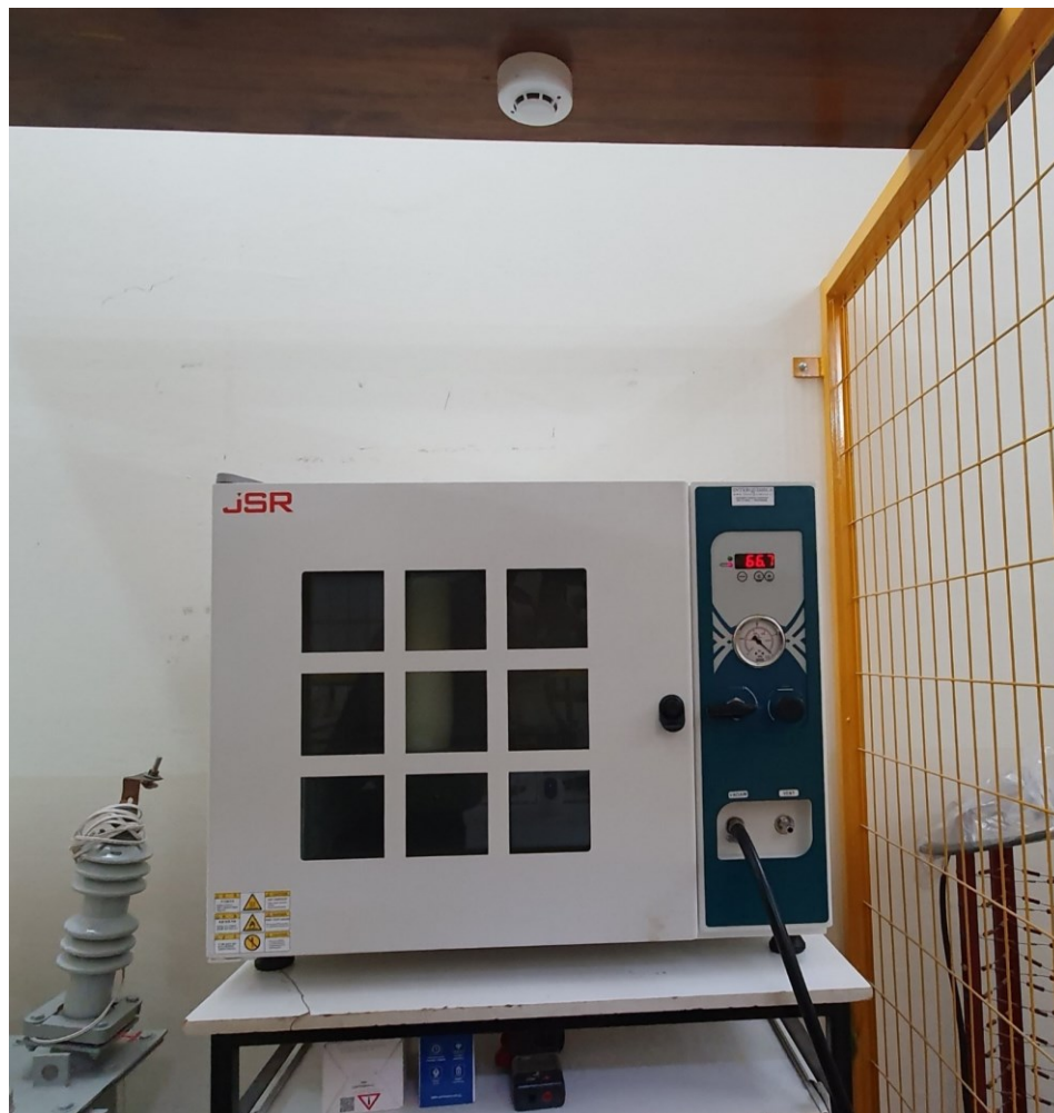
Figura D-1: Horno utilizado para los ciclos de temperatura de la prueba de envejecimiento acelerado de la probeta.
