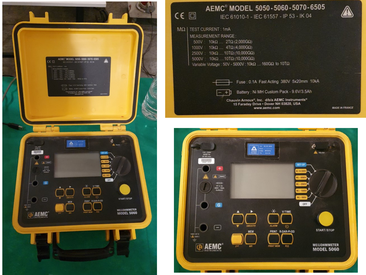
Figura D-9: Megaóhmetro AEMC® Model 5060, instrumento para la medida de R_a e IP.
