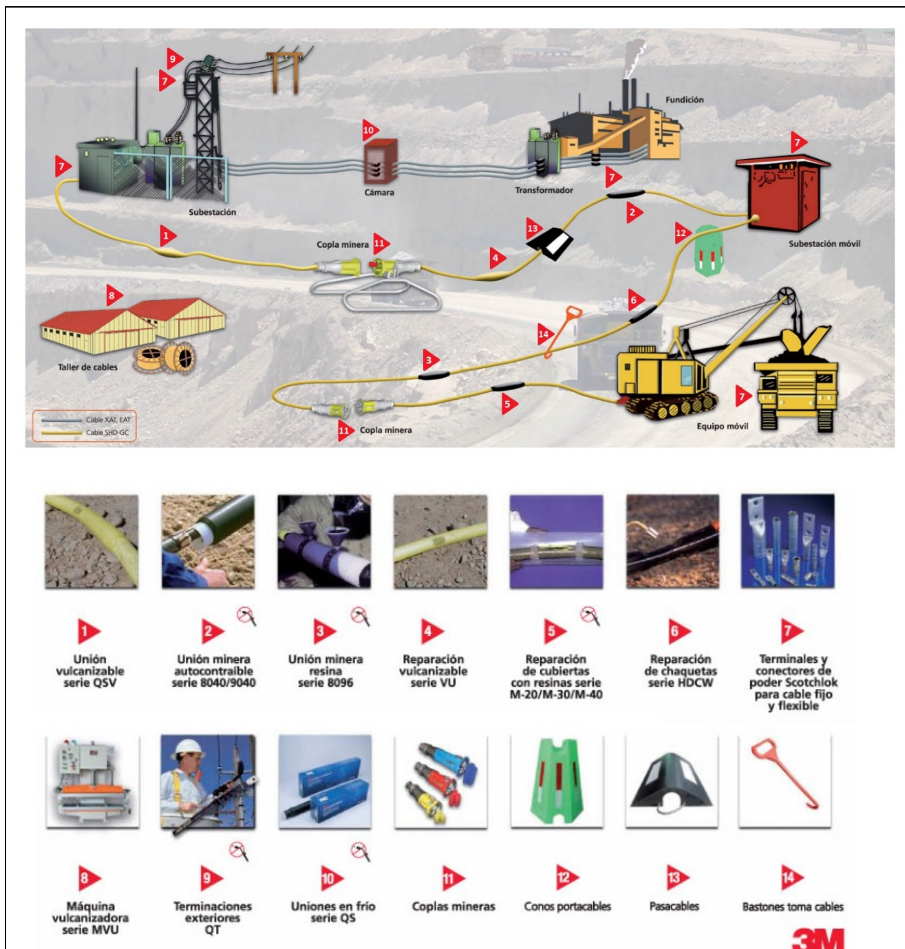
Figura 1-2: Ejemplo ilustrativo de un sistema eléctrico minero para la extracción de material y elementos comercializados por 3M Chile para la industria minera del país [2].
