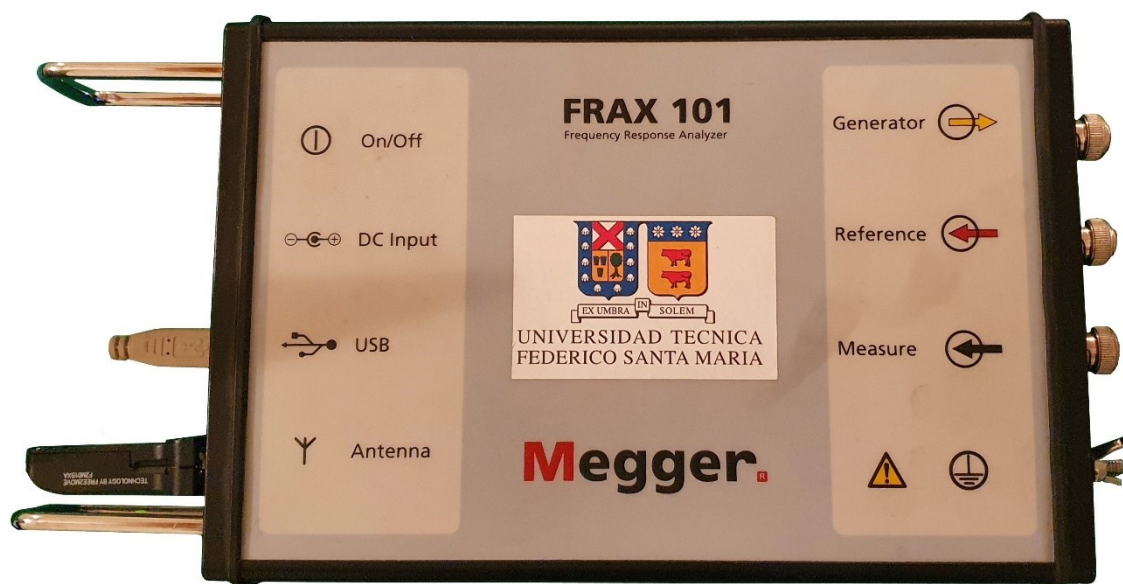
Figura D-16: Analizador de respuesta en frecuencia FRAX Model 101, instrumento de medida para la prueba FRA.
