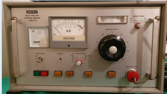
Figura D-14: Instrumentos utilizados para la medición de los parámetros de diagnóstico en AC (DP – \tan \delta y C).
