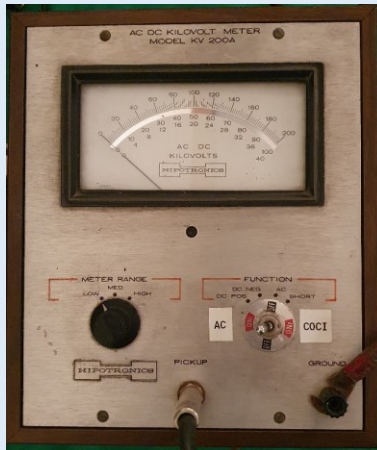
Voltímetro y Divisor de tensión capacitivo Cv1 y Cv2 HIPOTRONICS
