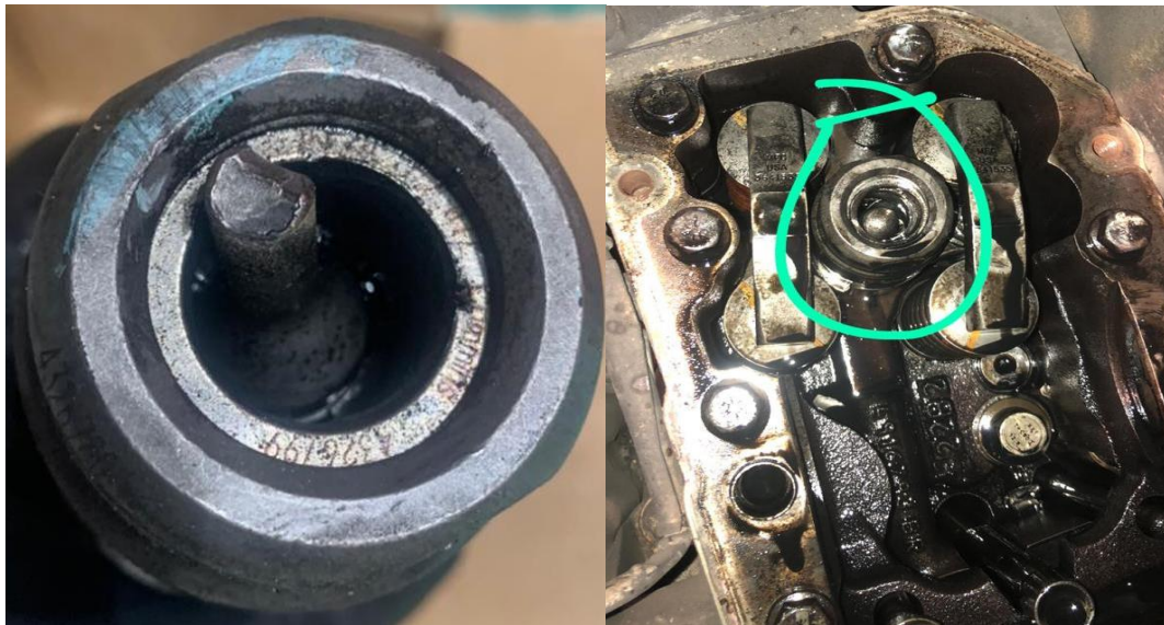
Figura 25: Inyector defectuoso y pérdida de lubricante.
