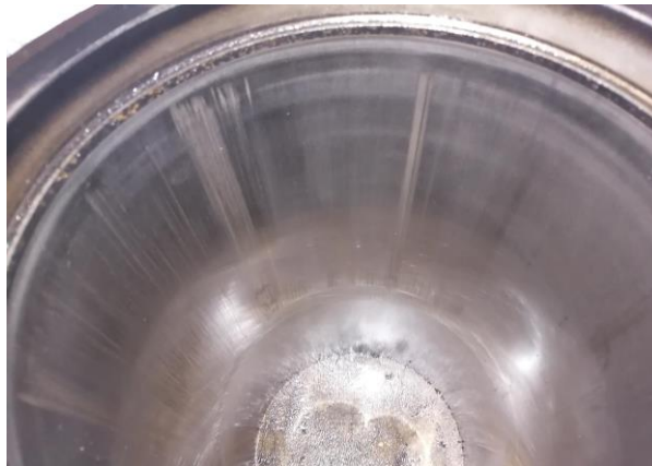
Figura 22: Rayadura interna de unidad de fuerza.
