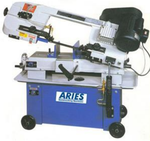
Figura 3-8: Sierra Horizontal de Huincha
