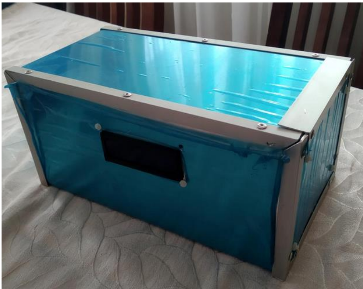
Figura 73 Contador de descargas atmosféricas construido.
