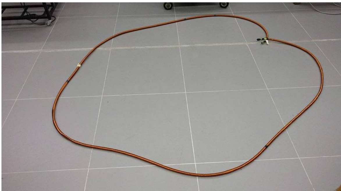
Figura 84 Bobina Rogowski 16000 vueltas terminada.
