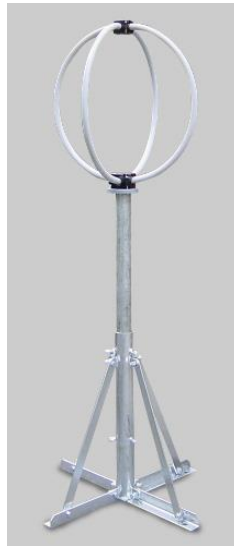
Figura 19 Dispositivo de medición por detección de Campo Magnético [41].
