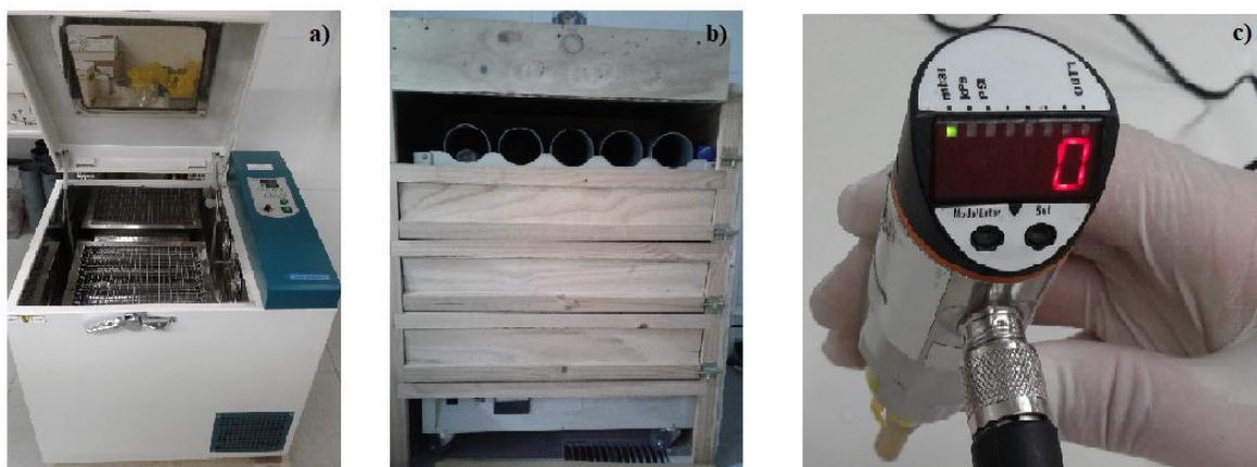
Figura 23. Equipos utilizados en la experimentación. (a) Shaker (b) Roller (c) Medidor de presión.
