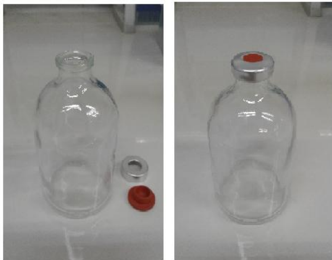
Figura 8. Botella Serum 120 ml para la digestión anaerobia.
