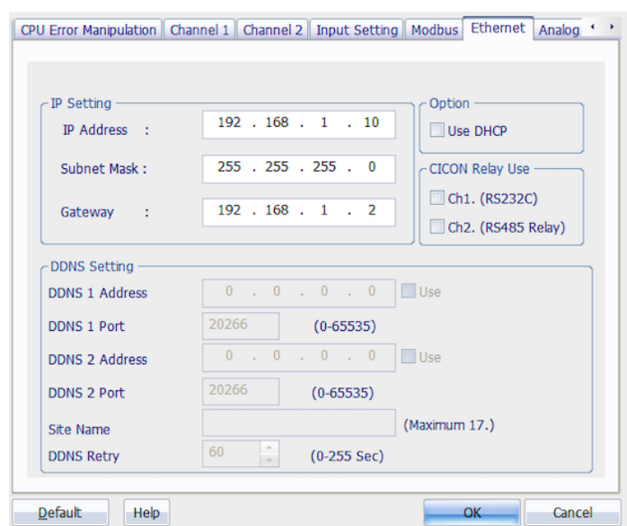
Figura 6-4 Parámetros protocolo Modbus TCP/IP
