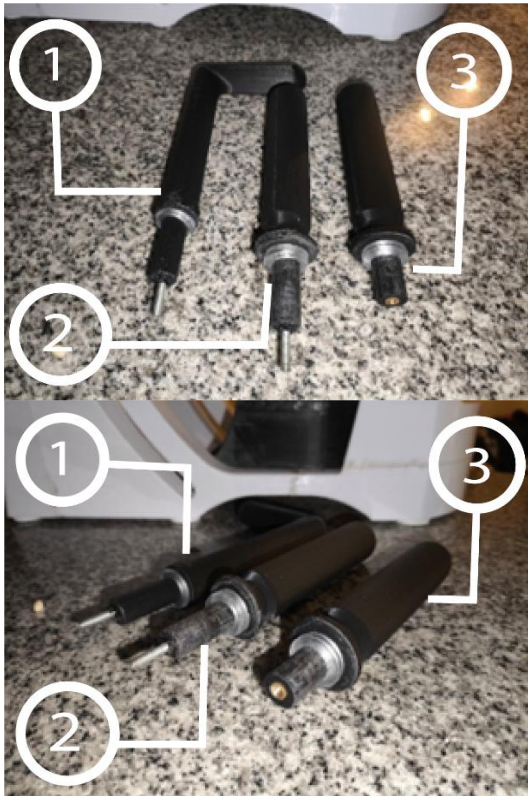
Figura 85 Cambios sistema de manilla 1) Manilla L. 2) Manilla Recta. 3) Manilla recta con inserto hembra, más corto.
