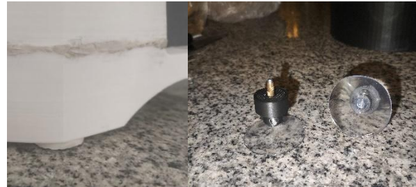
Figura 86 Cambio Antideslizante -> Ventosa
