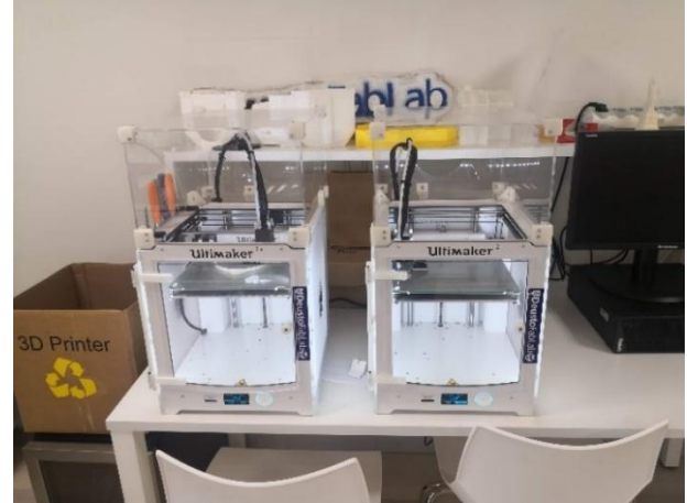
Figura 42 Proceso FDM, Ultimaker 2+, Deusto Fablab
