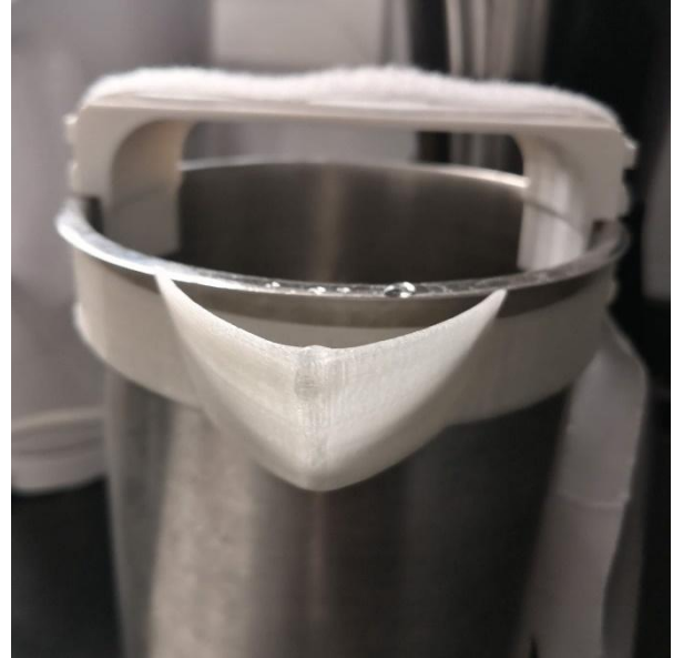
Figura 46 Ilustración 38 Prueba de agua, prototipo unión por amarre.
