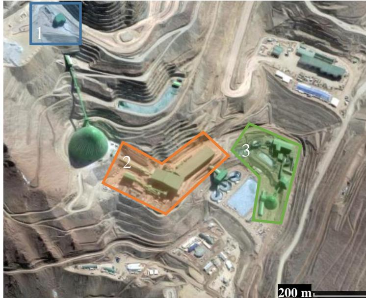
Figura 3-4: Principales áreas de la planta concentradora: (1) Chancado primario; (2) Molienda y flotación colectiva; (3) Flotación selectiva, filtros de concentrado y acopio de concentrados.
