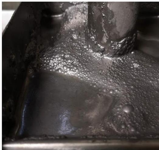
Figura 5-4. Espuma estable no generada por aireación de la pulpa.
