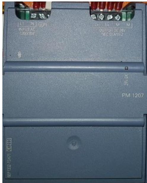
Figura 2-14. Fuente de alimentación PM 1207.
