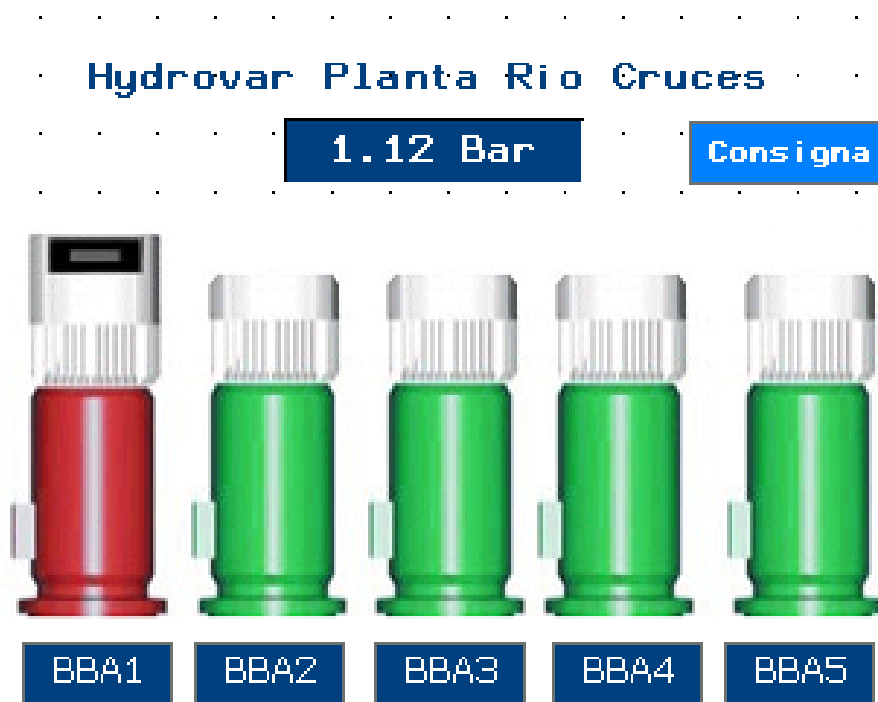
Figura 2-17. Ejemplo de interfaz HMI Magelis GTO.
