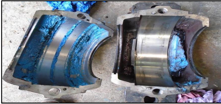
Figura 4- 23: tapas de soporte de rodamientos de VTI, se puede ver estado de grasa
