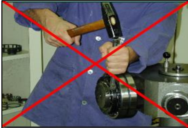
Figura 4- 16: Forma incorrecta de montaje de rodamientos
