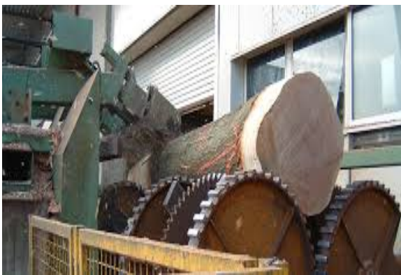
Ilustración 6 Descortezado mecánico con maquina descortezadora
