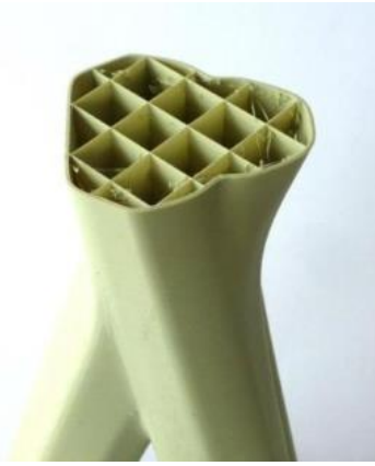
Ilustración 10: estructura interna de una pieza impresa en 3D. Fuente: www.imprimalia3d.com
