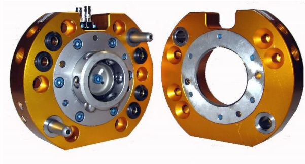
Ilustración 5: cambiador de herramientas ATI modelo QC76. A la izquierda el lado robot y la derecha el lado herramienta
