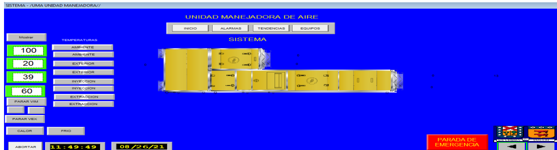
Figure 55. Display “INICIO” en la aplicación hmi
