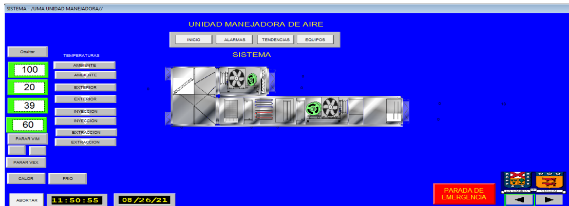
Figure 57. Display “SISTEMA” en la aplicación hmi
