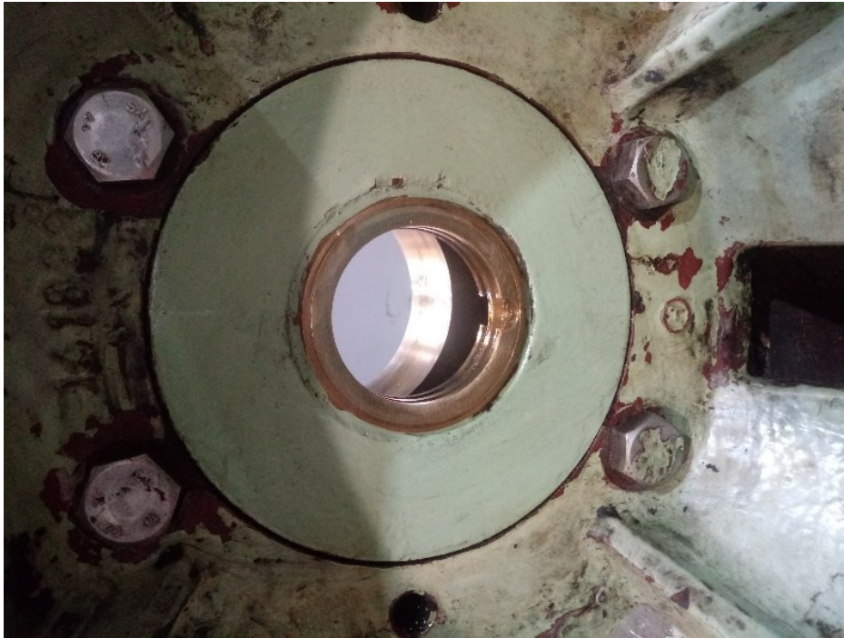
Figura 2- 11: anillo laberinto en tapa de caja rodaje lado impulsor.
