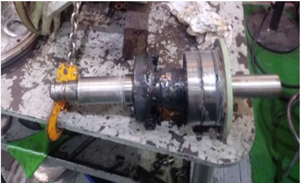
Figura 2- 10: Eje con rodamientos montados y tapa de caja rodaje.
