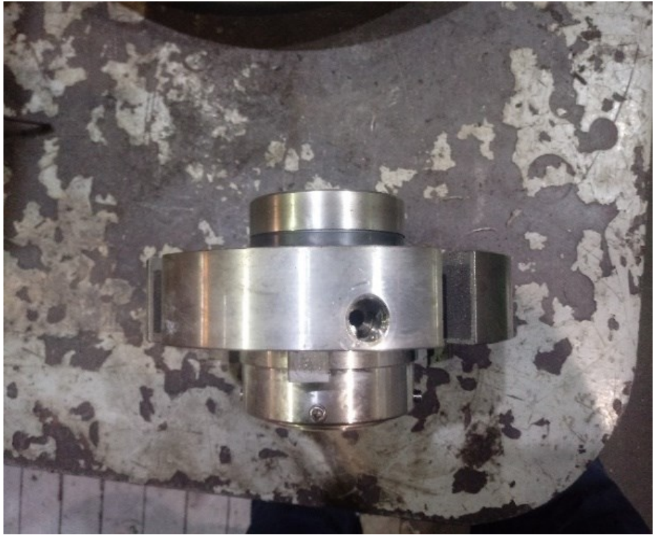
Figura 2- 9: sello mecánico vista lateral.
