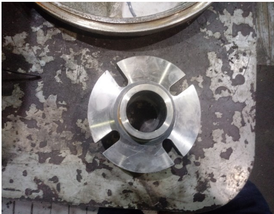
Figura 2- 8: Sello mecánico doble 50 mm.
