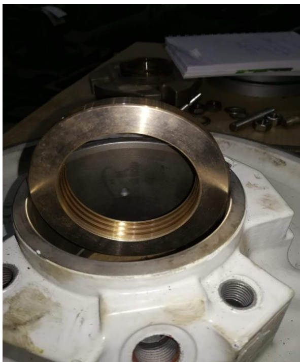
Figura 4- 1: anillo fondo de caja fabricado en taller de máquinas y herramientas de maestranza Celulosa Arauco.
