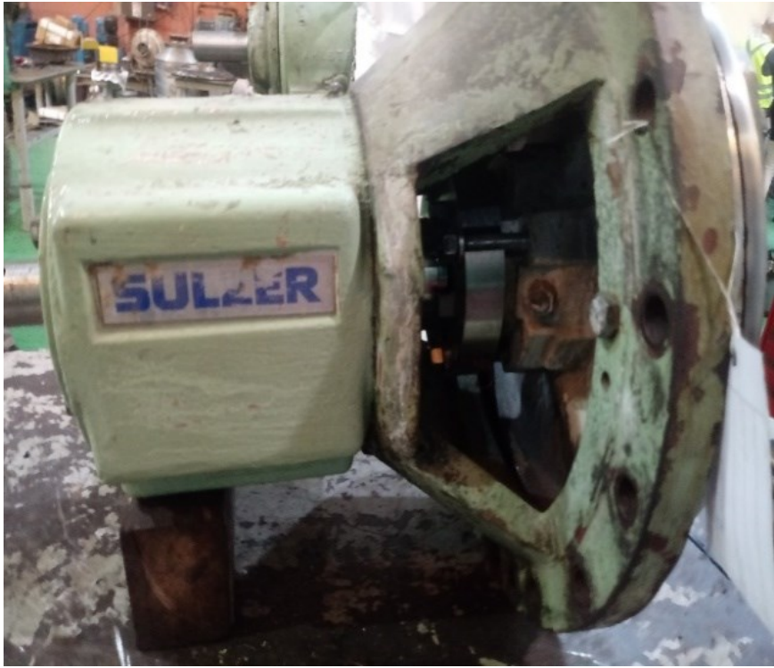
Figura 2- 3: Bomba centrífuga en mesón para peritaje.
