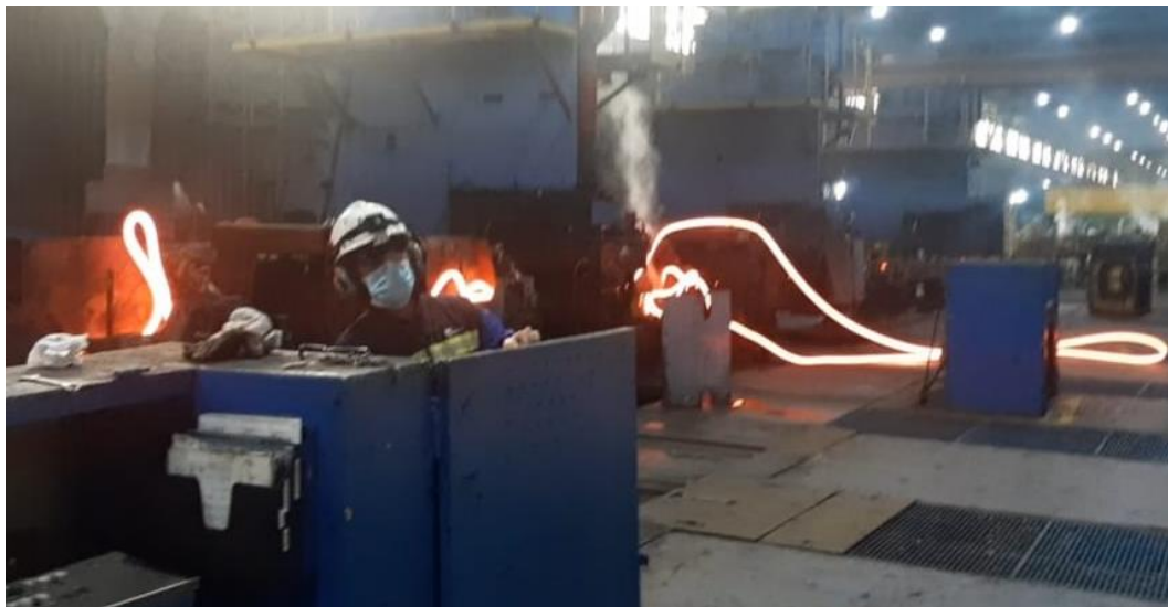
Figura 2.2: Cobble en tren medio por trabamiento de barra en un stand.
