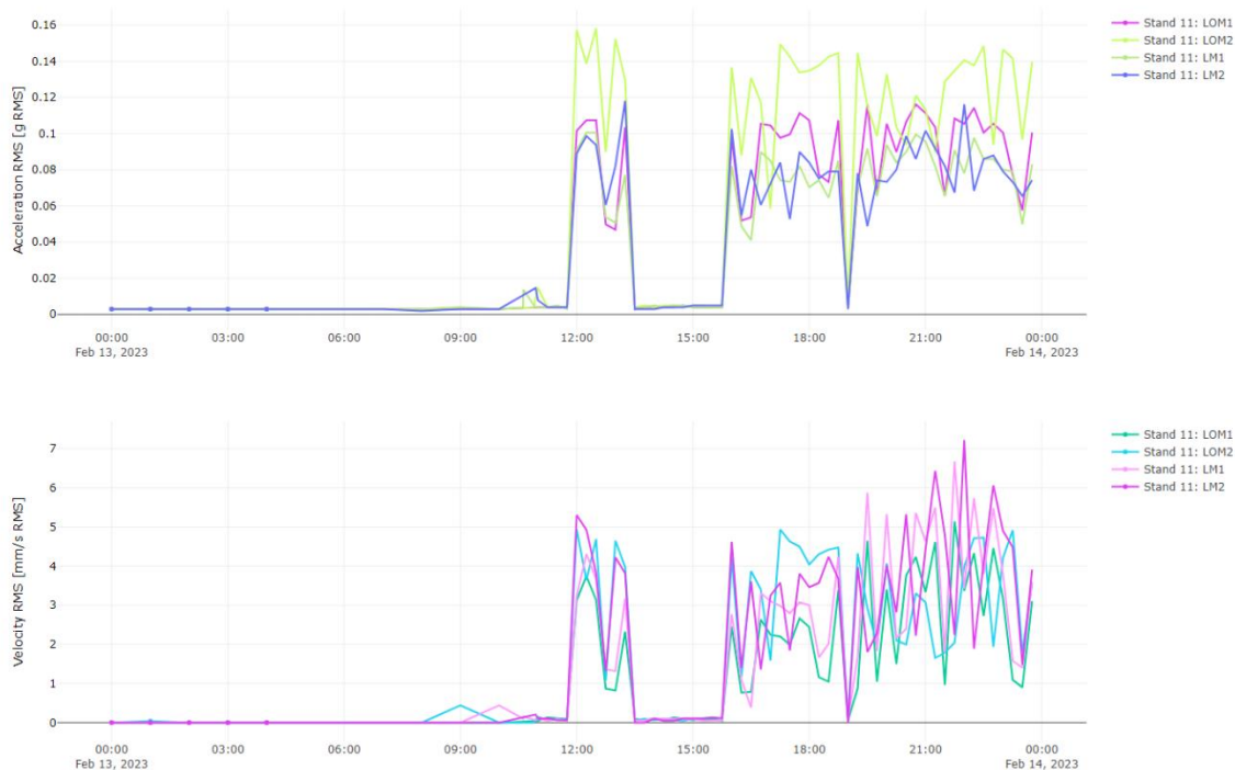
Figura 6.9: Gráficos de aceleración y velocidad para 4 sensores.
