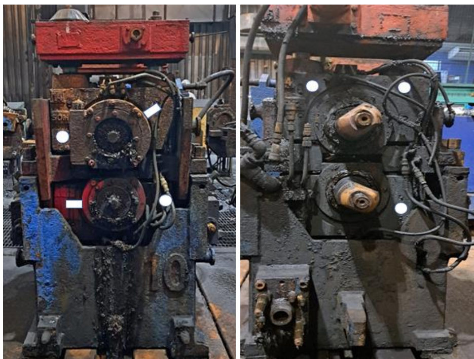
Figura 6.1: Definición de posiciones de los sensores en stand M11H.
