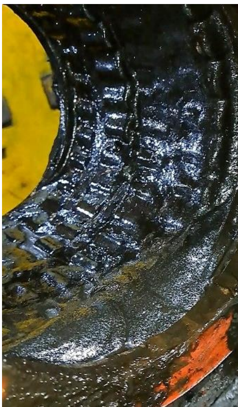
Figura 6.12: Estado rodamiento bastidor superior LM, stand M11H.
