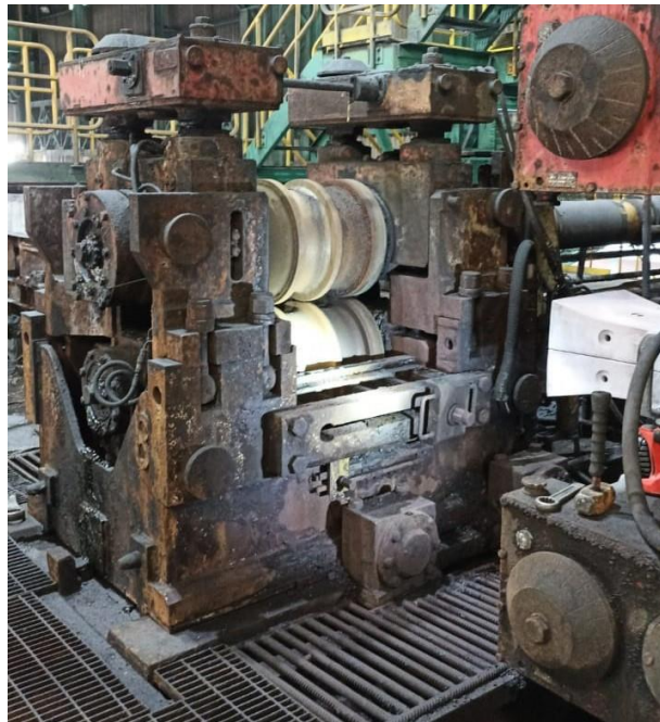
Figura 2.1: Stand o caja de laminación en caliente D1H.
