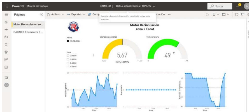
Figura 5.11: Ejemplo de visualización en Power BI de un monitoreo de vibraciones realizado por RYASA MX.
