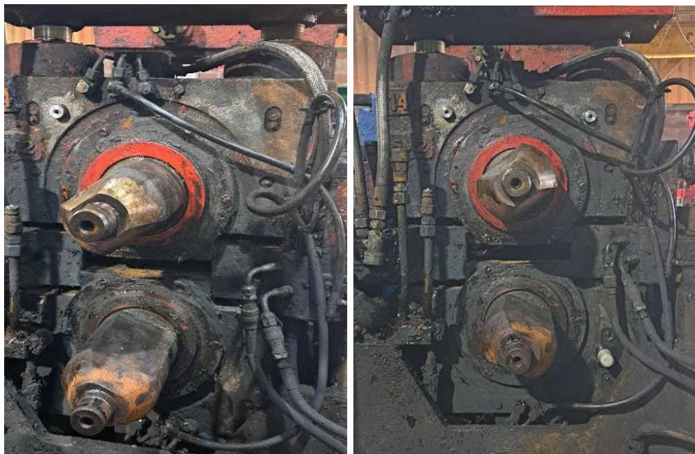
Figura 6.4: Instalación de bases para sensores al stand M11H.
