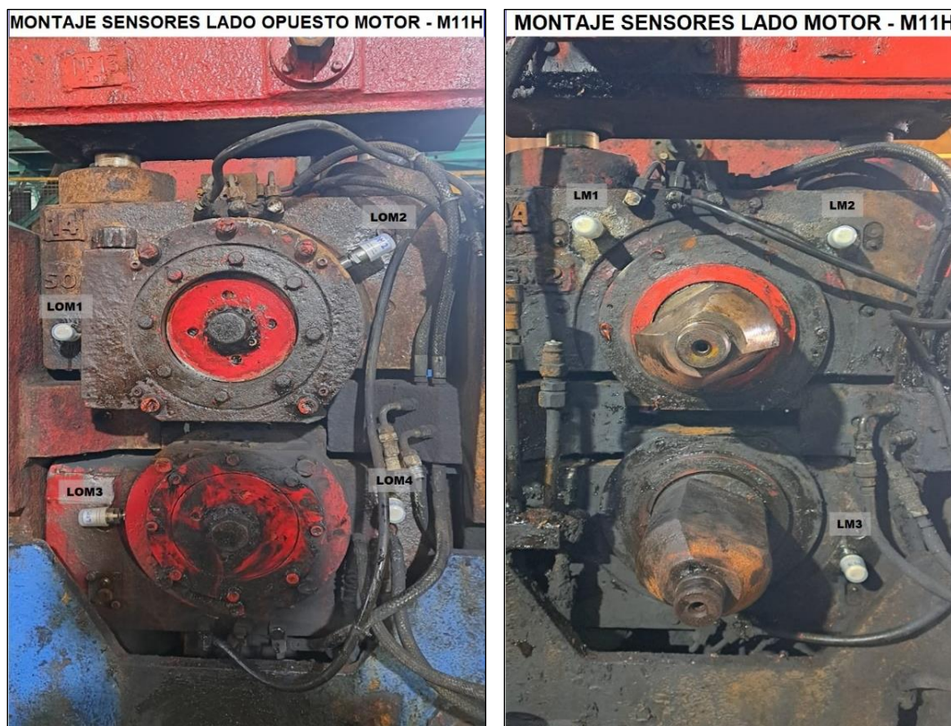
Figura 6.6: Padrón de montaje de sensores acelerómetros en stand M11H.
