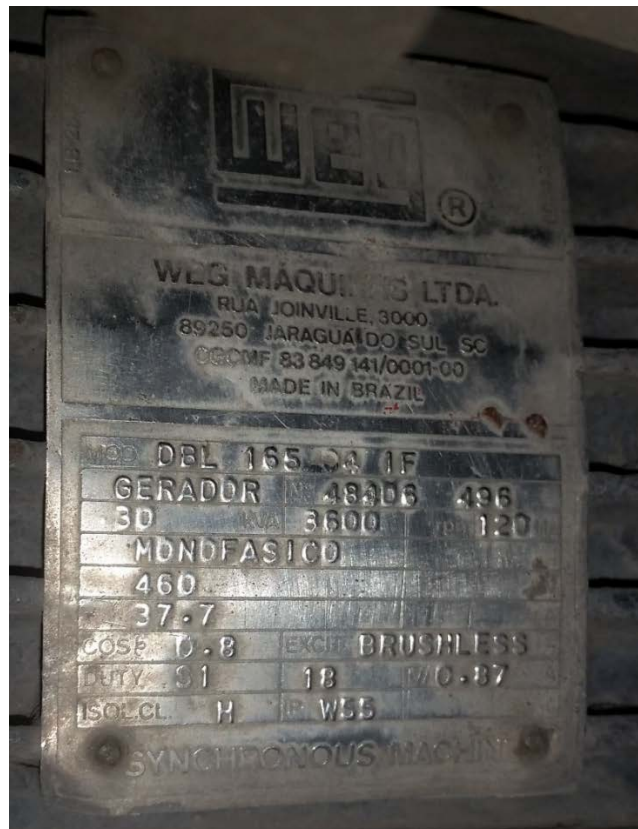
Figura 4- 11 Placa de características generador
