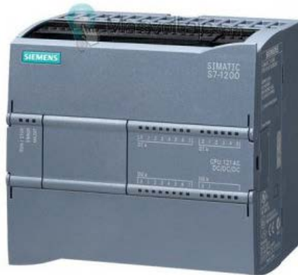
Figura 4- 5 PLC Siemens S7-1200
