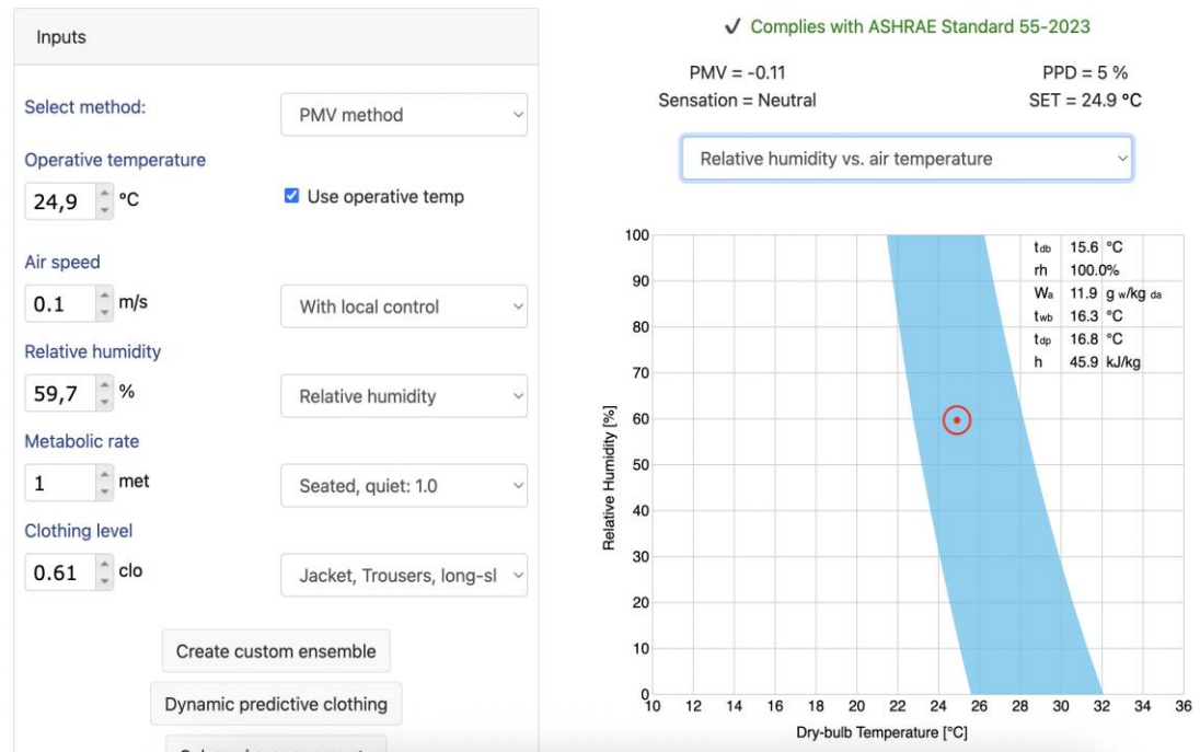
figura 4-8 Análisis de confort térmico según ASHRAE 55 en sala de espera urgencias Fuente: Software center for the built environment
