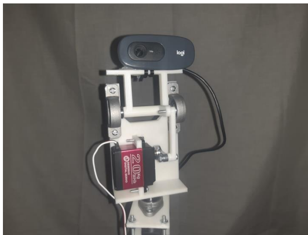
Figura 3-2. Fotografía mecanismo de movimiento de Webcam
