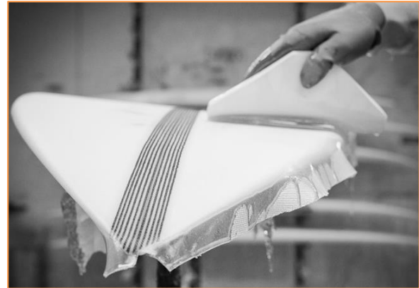
Imagen 1.2.11 Proceso de laminación (glassing), etapa 2 / Fuente: (The Inertia, 2015)
