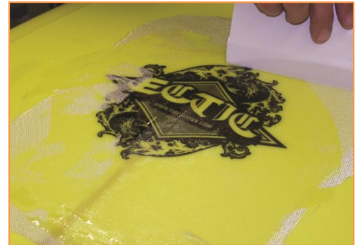
Imagen 1.3.4 Calcomanía impresa en papel de arroz y adherida con resina / Fuente: (Surf Educators, 2017)
