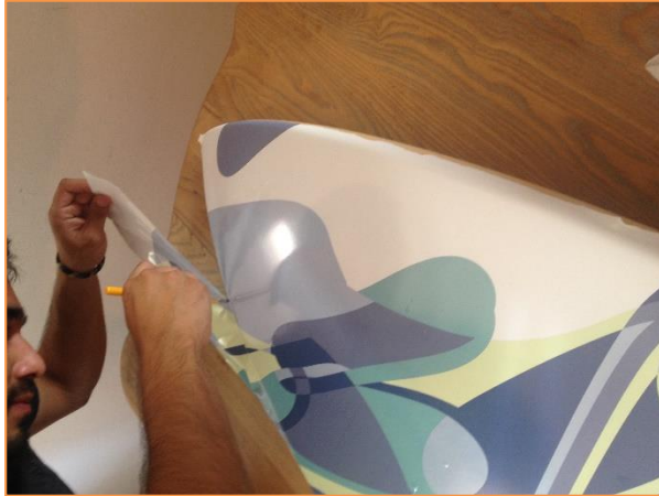
Imagen 3.10.5 Eliminación de excedentes de material adhesivo
