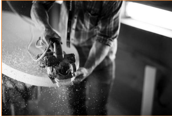
Imagen 1.2.10 Etapa 1, proceso de forma con cepillo eléctrico / Fuente: (The Inertia, 2015)
