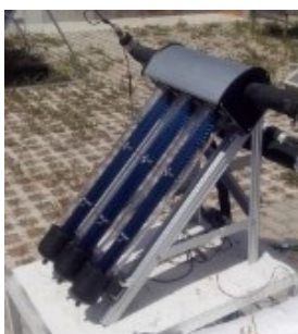
Figura 3.4: Colector solar pequeño de tubos al vacío con sistema heat pipe
