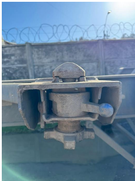
Figura 3.11 Punto de anclaje contenedores
