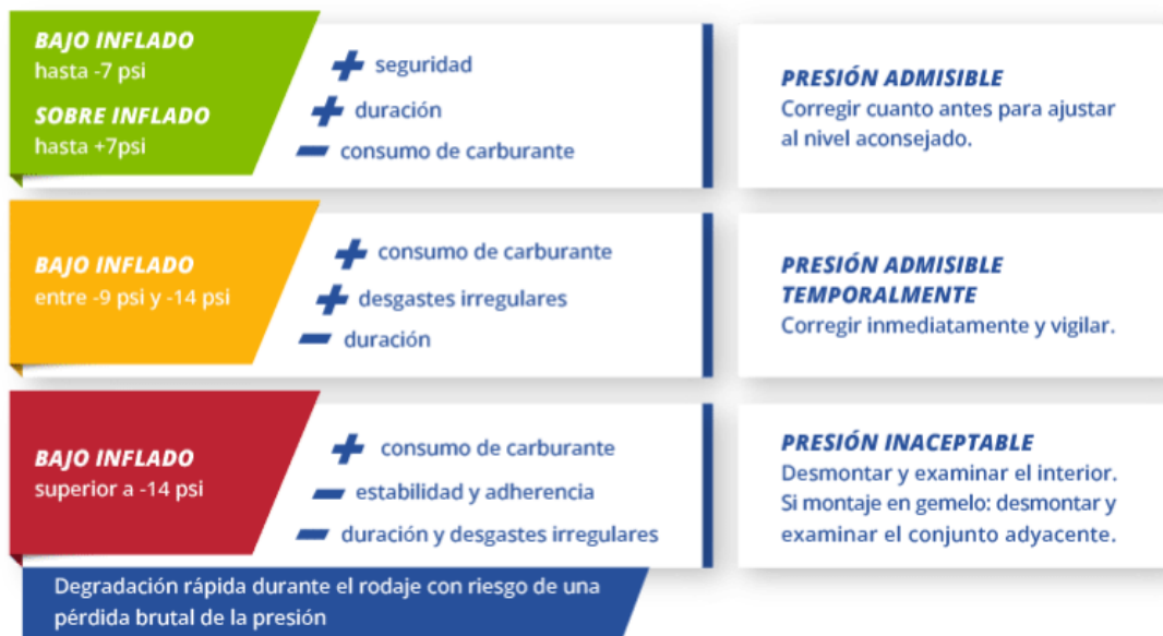
Figura 3.4 parámetros de presión de los neumáticos
