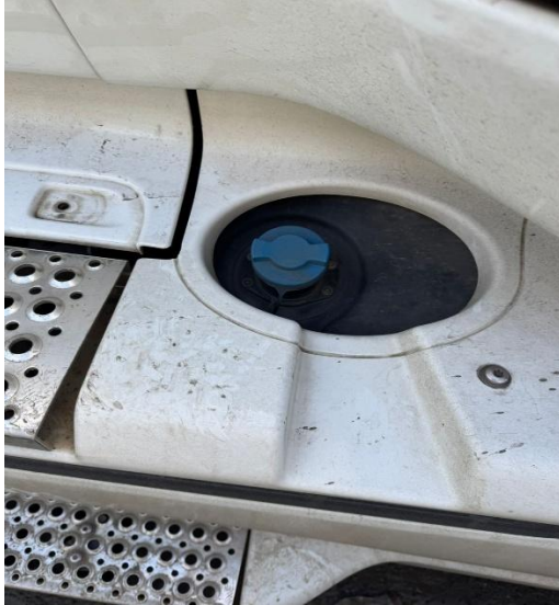
Figura 3.19 Referencia del estanque aceite hidraulico
