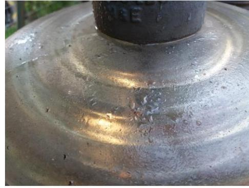
Fotografía 26. Estado hidrófobo de aislador degradado de la intemperie durante dos meses después de ensayo húmedo
