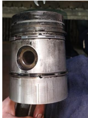
Figura 14: pistón con zona agripada
