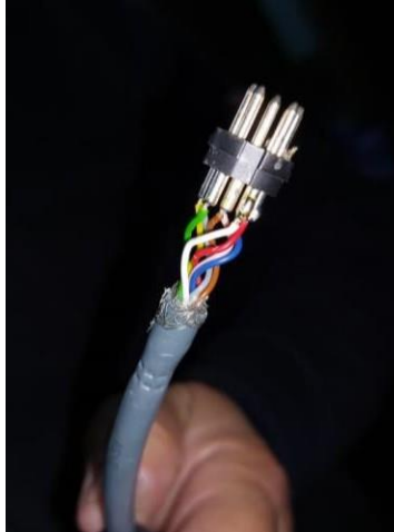
Figura 24: extensión fabricada para conexión a encoder
