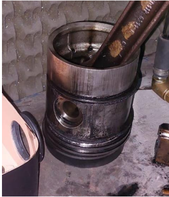
Figura 10: Pistón y anillos recién extraídos
