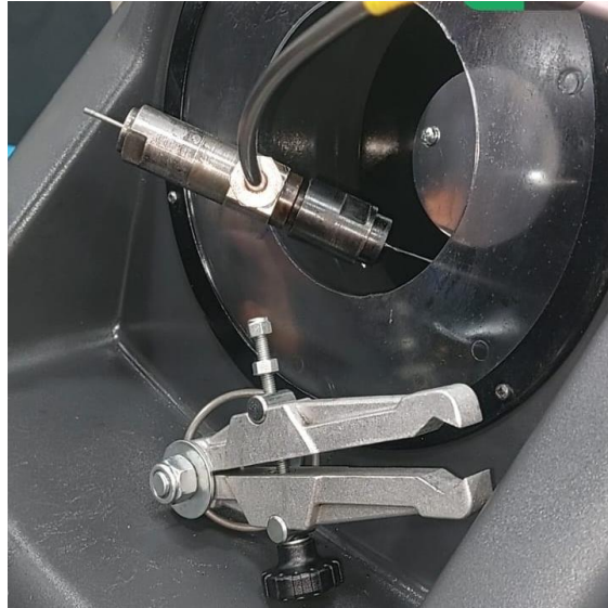
Figura 7: Inyector en banco de prueba expulsando chorro de combustible
