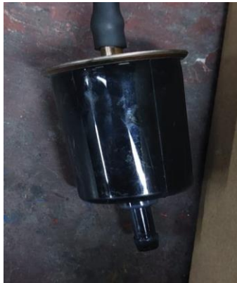
Figura 6: Filtro de sonda de gases de escape bloqueado con aceite
