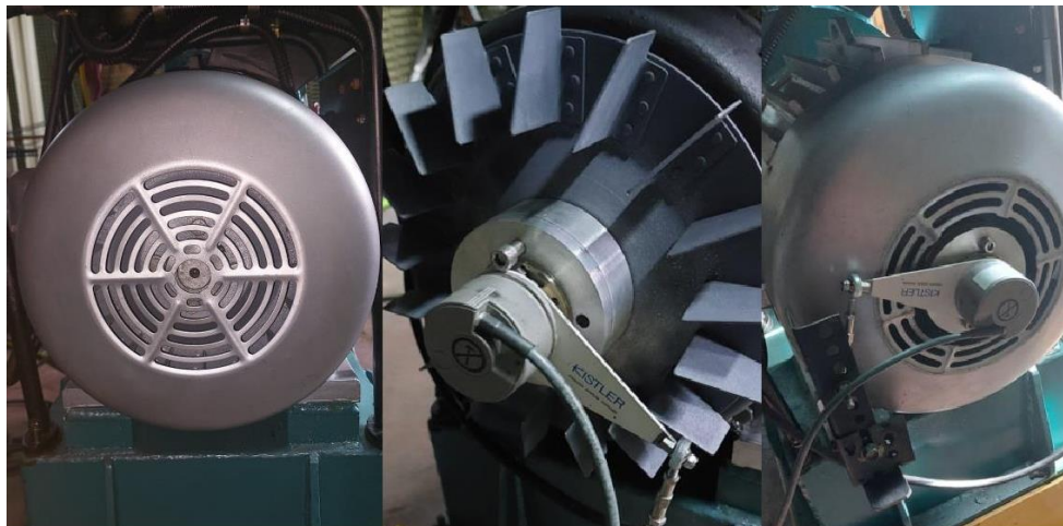
Figura 23: montaje de encoder a motor eléctrico
