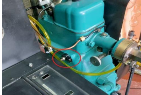
Figura 21: posición de sensor de knock en bloque de motor
