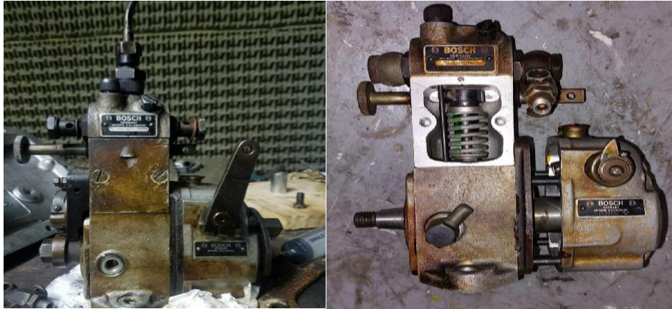
Figura 8: Bomba inyectora de combustible, izquierda: tapa y ranura de drenado; derecha: vista sin tapa y visibilización de ranura helicoidal de ajuste
