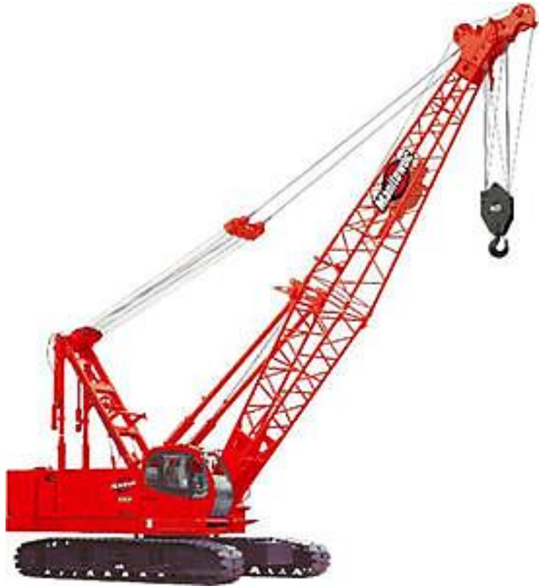
Ilustración 1-8 Grúa con Pluma de Celosía (Fuente: www.directindustry.es )
