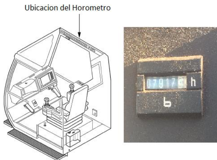
Ilustración 4-1 Horómetro de trabajo de la Grúa (Fuente: Manual de Instrucciones de uso Liebherr 1160.5-2)
