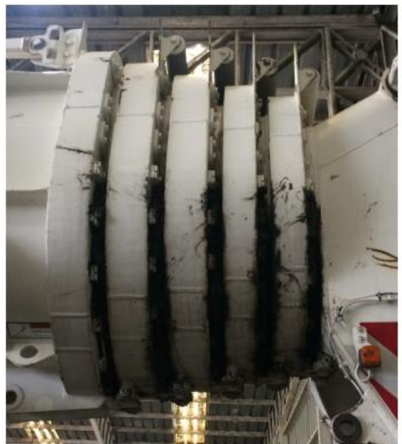
Ilustración 4-11 Pluma Recién Engrasada (Fuente: Elaboración Propia)
