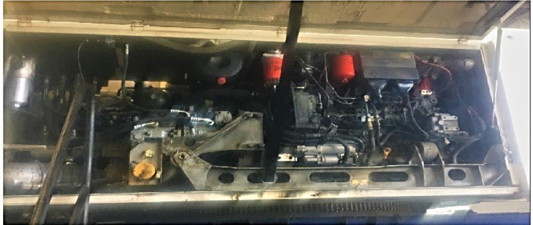
Ilustración 2-14 Conjunto Motor y Bombas Hidráulicas de la Grúa. (Fuente: Catalogo de Repuestos Liebherr LTM 1160 y elaboración Propia)
