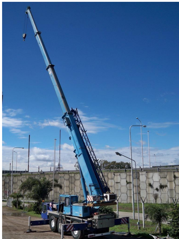
Ilustración 1-9 Grúa con Pluma Telescópica. (Fuente: www.demag.com )
