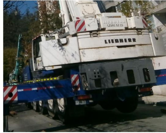
Ilustración 2-4 Contrapesos de la Grúa (Fuente: LTM 1160.5-1 Caracteristiques Manual y Elaboración Propia)
