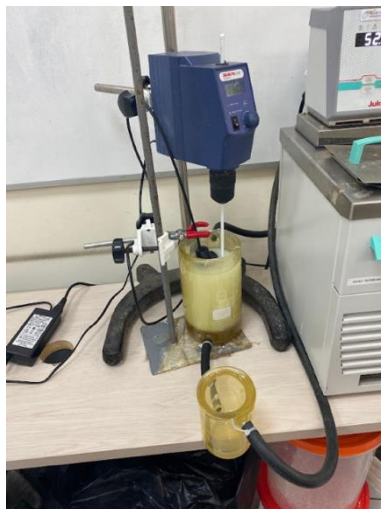
Figura 10. Configuración de experimentos de evaluación cinética de precipitación.
