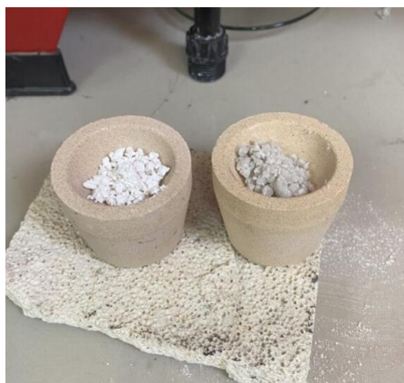
Figura 14. Diferencia de color entre el óxido y el hidróxido de magnesio formado.
