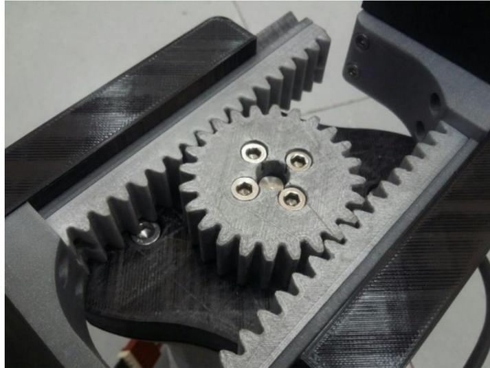
Ilustración 39: sistema de transmisión de gripper LaGara
