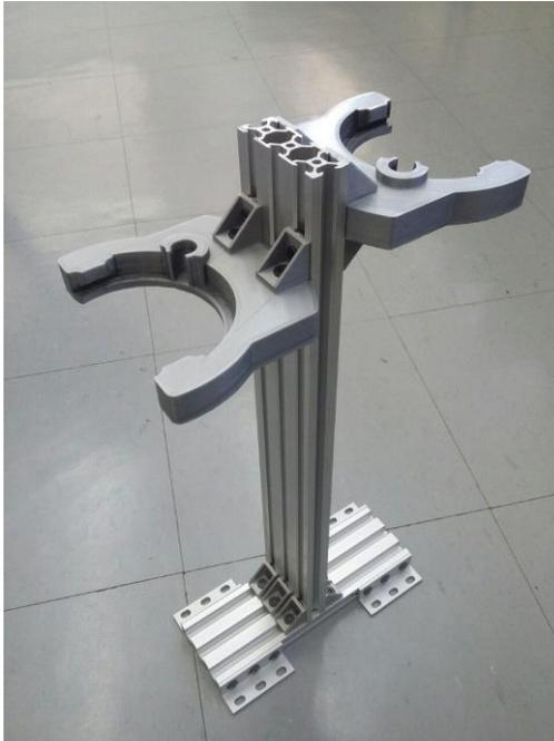
Ilustración 42: Stands y columna porta stand en ensamble.
