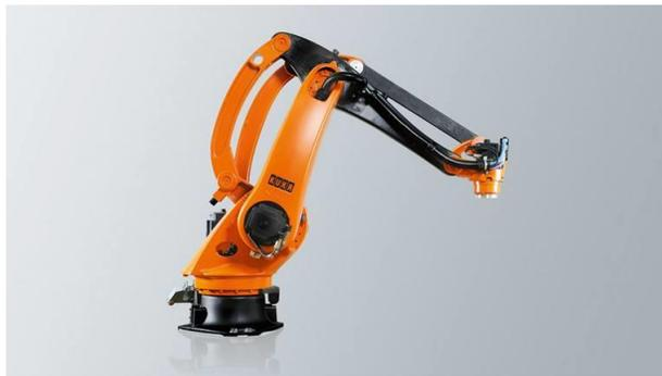
Ilustración 1: Robot Kuka KR40 PA
