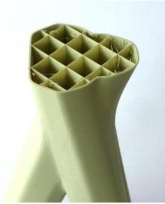
Ilustración 10: estructura interna de una pieza impresa en 3D. Fuente: [www.imprimalia3d.com](http://www.imprimalia3d.com)
