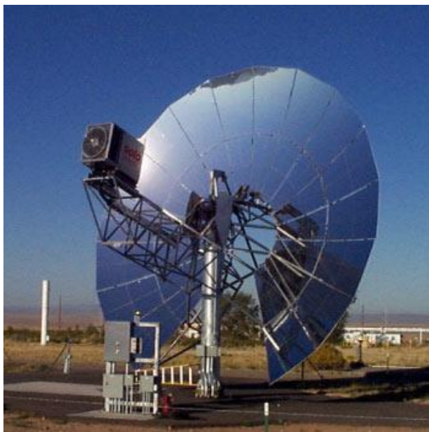
Ilustración 7: Colector de Disco Parabólico con motor Stirling en su foco. [5]
