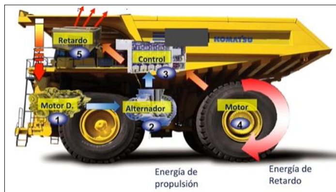
Figura 1-2. Secuencia de trabajo de sistema de retardo. Fuente: Curso de familiarización de equipos Komatsu CaEx.
