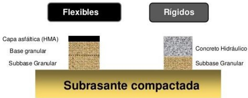
*Figura 7: Pavimento flexible y rígidos*
