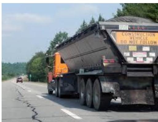
*Figura 63: reconstrucción carpeta, transporte de mezcla asfáltica*
