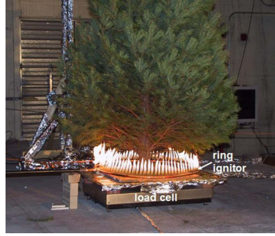
Figura 3.12: fotografía que muestra el arreglo dispuesto para la quema de un árbol de 2 m de altura. En particular, se destaca el sistema tipo anillo que sirve para producir la ignición de la copa.
