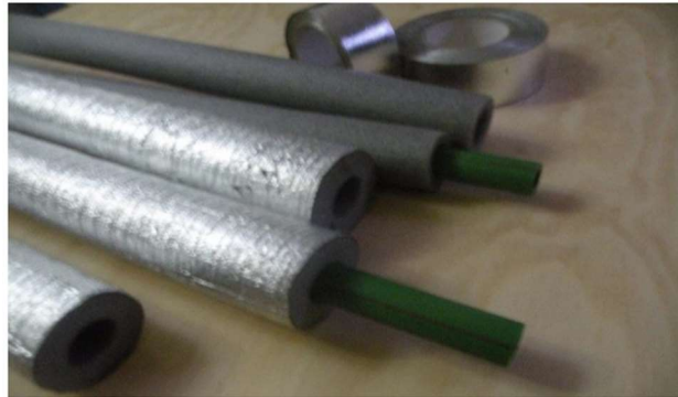
Figura 1-9 Tubería ppr con aislación térmica
