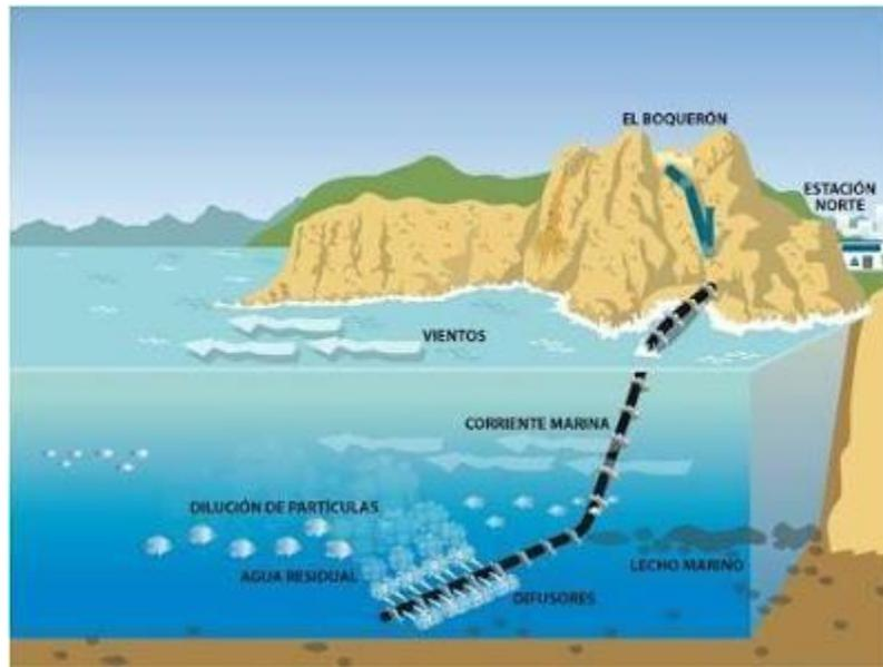
Ilustración 5 Esquema de funcionamiento de un emisario submarino
