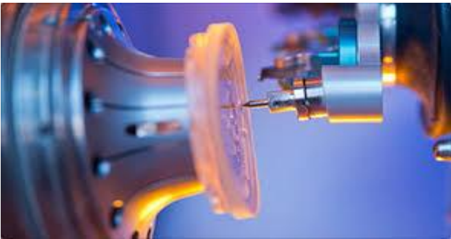
Figura 2-4: Grabado de lente con punta de herramienta separada. Fuente: Adaptado de Satisloh (2024)
