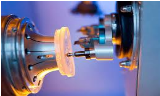
Figura 1-3: Etapa de giro fino Fuente: Adaptado de Satisloh (2024)
