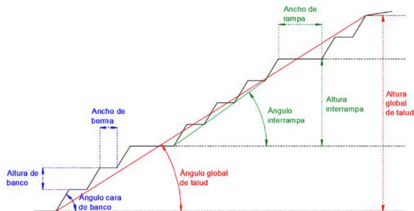
Figura 4: Ángulo de talud global Fuente: [Díaz Pizarro, 2017]
