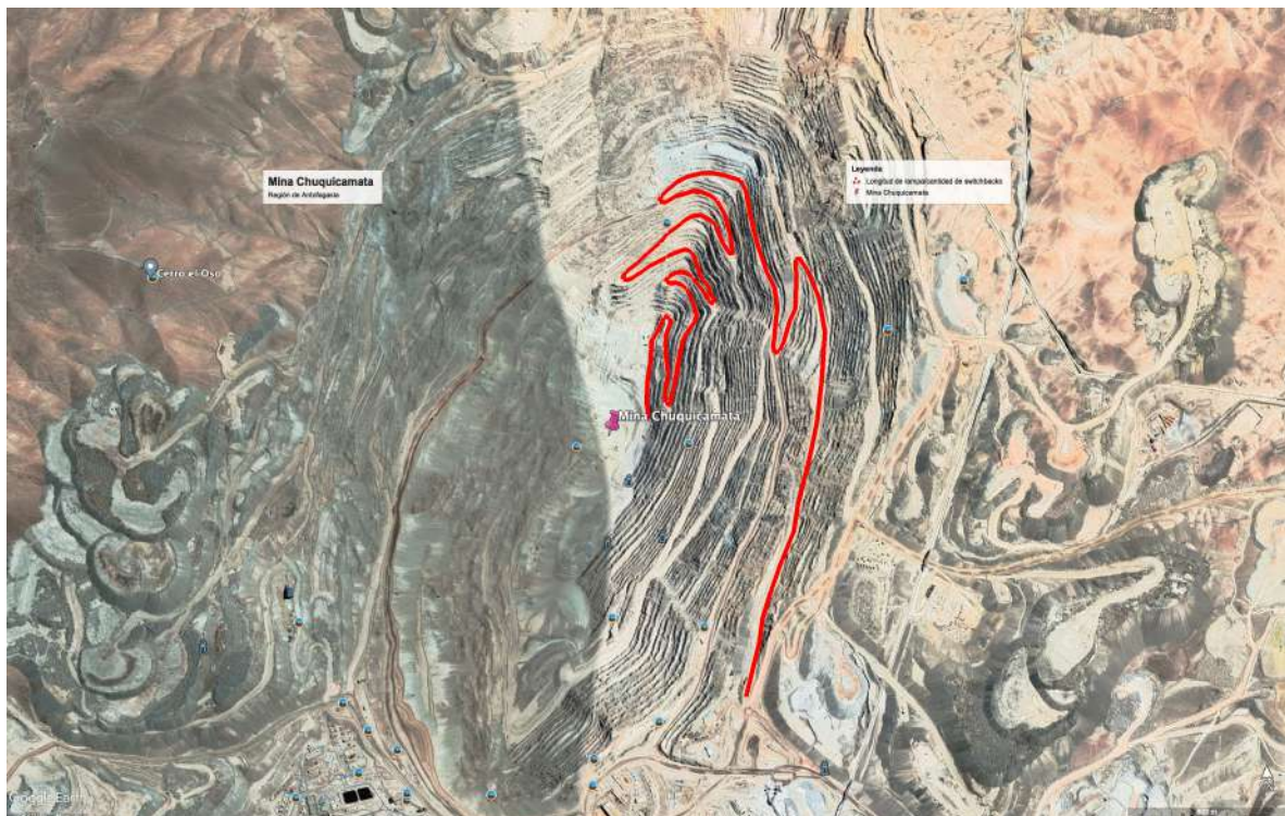
Figura 33: Medición de Longitud de rampa Fuente: Elaboración propia mediante Google Earth Pro
