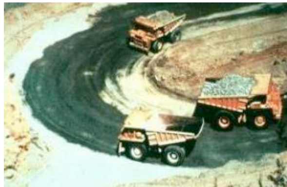
Figura 7: Curva en U en rampa Fuente: [Chebair y Yanes, 2020]
