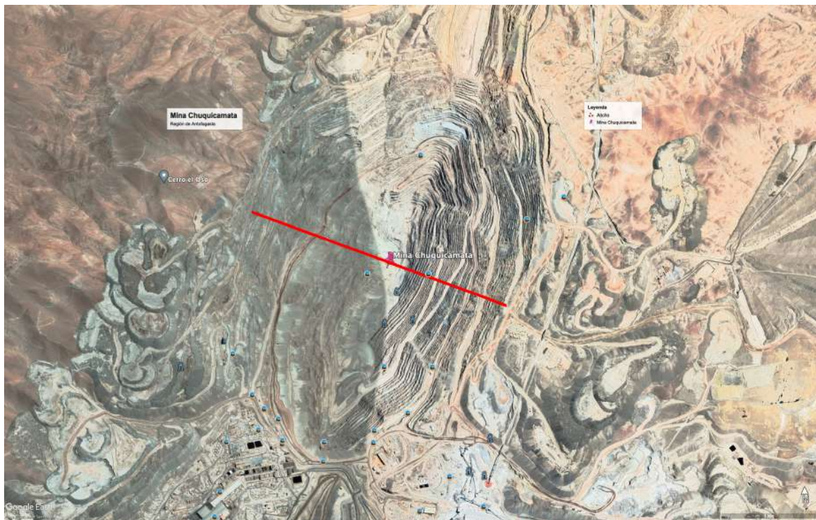
Figura 27: Medición de Ancho de rajo Fuente: Elaboración propia mediante Google Earth Pro
