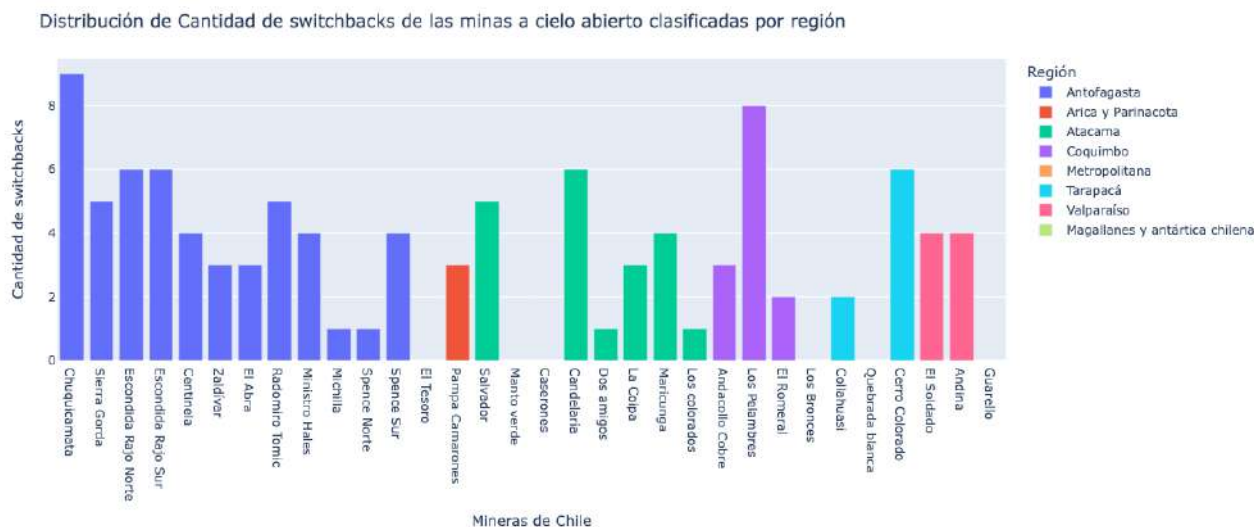
Figura 19: Parámetro geométrico - Cantidad de switchbacks
