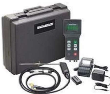
Figura 15: Equipo electroquímico para realizar mediciones de CO 2 y O 2 . Fuente: Sepúlveda,(2017).
