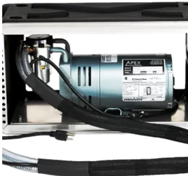
Figura 22. Bomba adosada a la unidad de control
