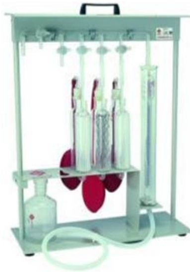
Figura 16: Equipo analizador Orsat para realizar mediciones de CO 2 y O 2 . Fuente: Sepúlveda, (2017).
