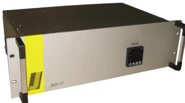
Figura 32. Convertidor NO 2 a NO, Marca JCT Fuente: https://www.jct-gs.com
