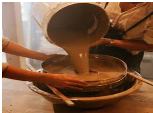
FIGURA 8: FABRICACIÓN DE BARBOTINA
