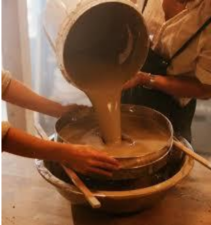
FIGURA 1.19: FABRICACIÓN DE BARBOTINA
