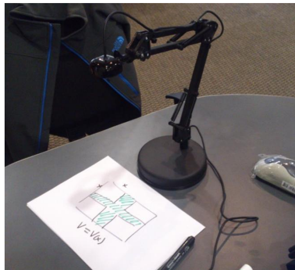
Imagen 3.8: Captador de imagen artesanal, compuesto por un soporte de lámpara y una webcam utilizado en las intervenciones.
