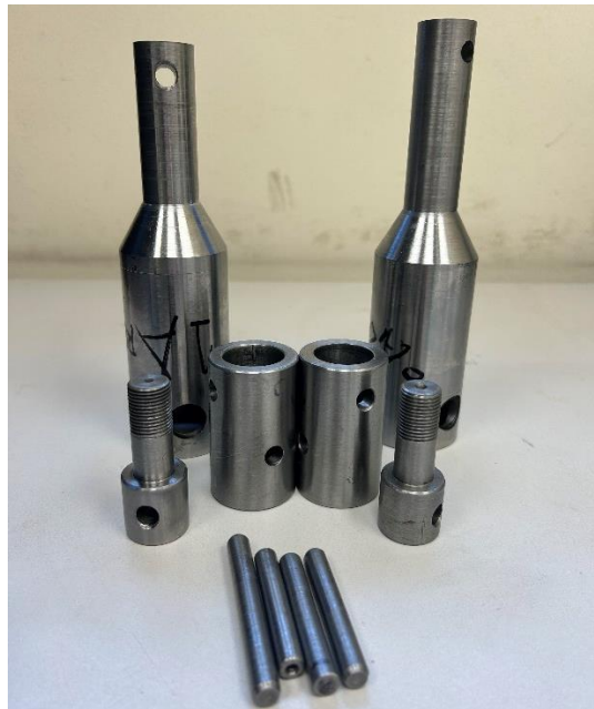
Figura 19. Sistema de holders y mordazas según norma ASTM633
