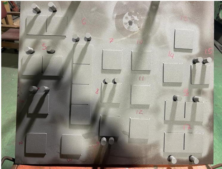
Figura 14. Piezas soldadas a la mesa para facilitar la aplicación del recubrimiento
