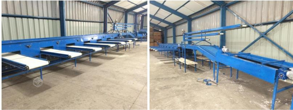
Ilustración 24: Máquina calibradora y sus especificaciones
