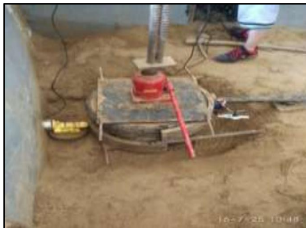
Figura 4.1 Ensayo de corte directo dos Neumáticos. Ge, Wang, Song, Ma, Zhang, Li & Cui (2017).
